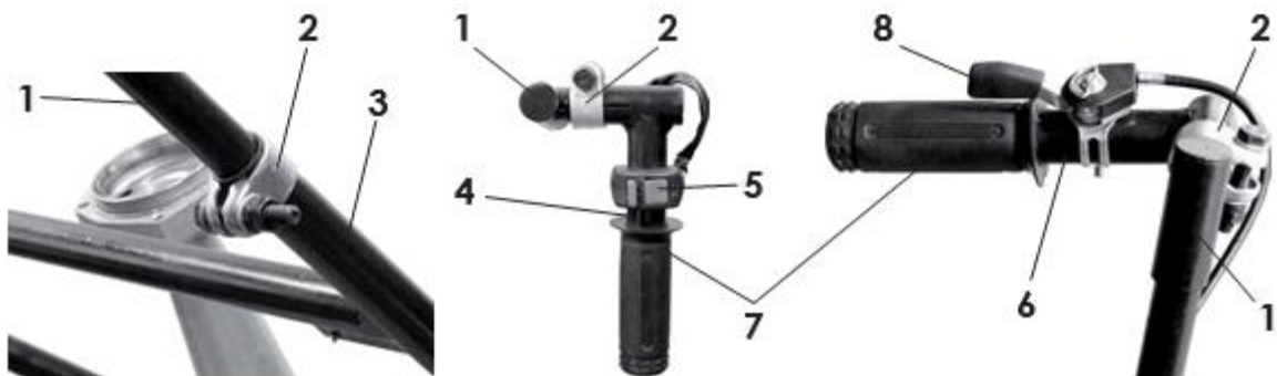
Рис. 2 - Установка стоек с рукоятками управления
